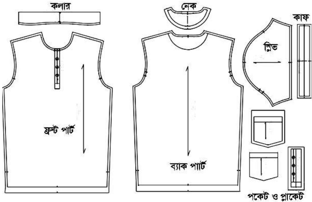
চিত্র ১.১-৬: একটি পোলো শার্টের বিভিন্ন অংশের প্যাটার্ন
