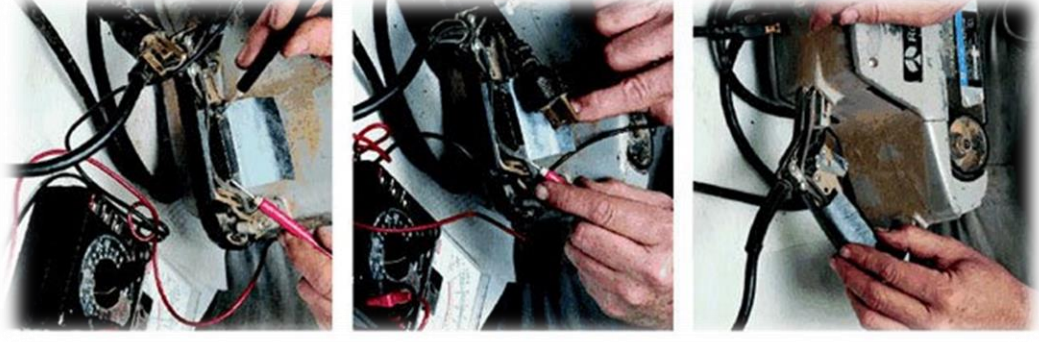
চিত্রঃ পাওয়ার ড্রিল মেশিনের কয়েল টেস্ট।
