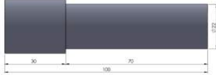
চিত্র ২- স্ট্রেইট টার্নিং শেষে জবের অবস্থা
